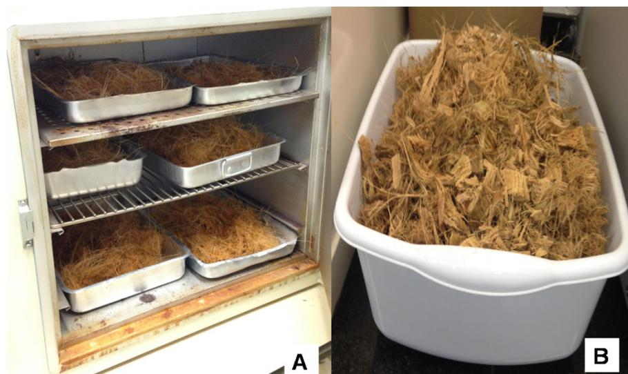
Figura 2— (A) Secagem em bandejas, na estufa, e (B) Fibras secas, antes da moagem
