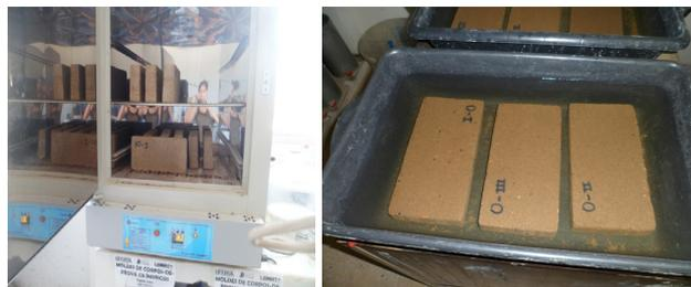
Figura 4: Tijolos na estufa e mergulhados na água.
