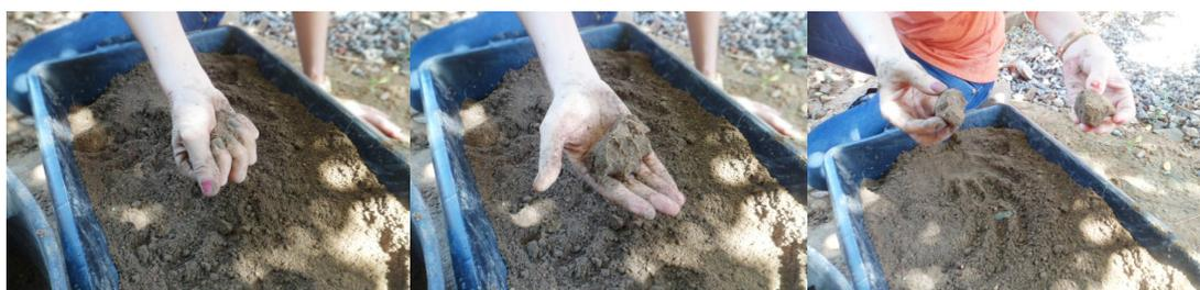
Figura 2: Teste da umidade para prensar os blocos.
