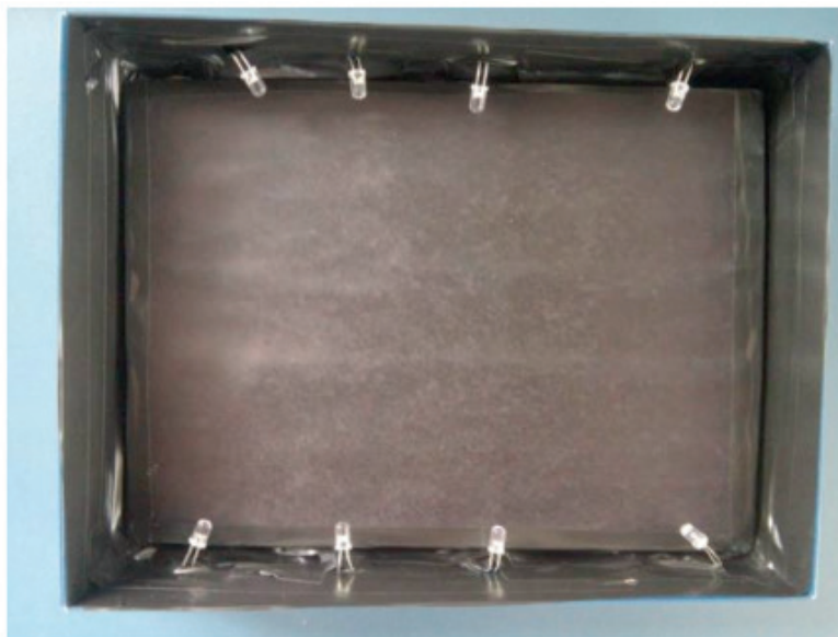
Figura 6 – Caixa Retangular com circuito embutido e LEDES fixados na lateral.
