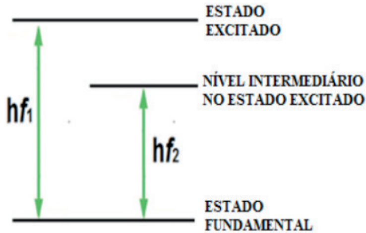
Figura 3 - Esquema Simplificado entre as diferenças de energias dos estados.
