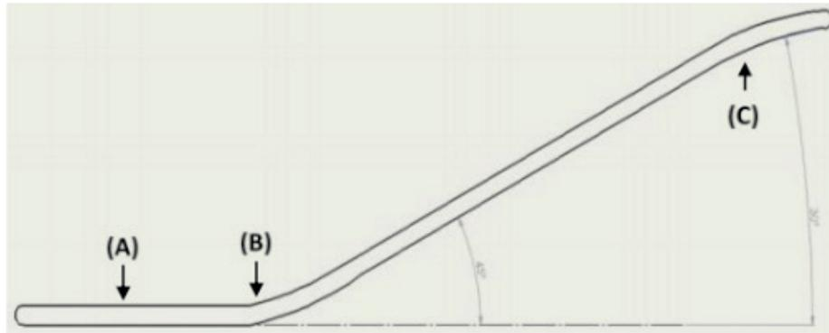
**Figura 1:** Esquema do transportador analisado. Posição horizontal inicial em (A). Em (B), o trilho apresenta inclinação em rampa de 45 graus. O declive é reduzido em (C). Na extremidade superior, os carrinhos giram, descarregam o clínquer e retornam para o início por baixo do trilho. Fonte: Autor (2017)
