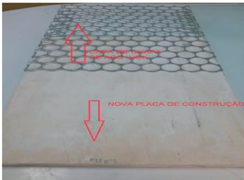
Figura 2 – Vista Frontal da nova Placa de construção com a capa de aço inox.
