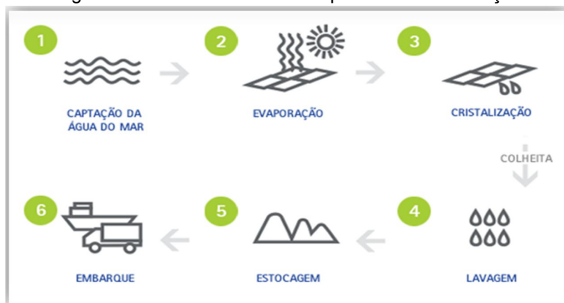
Figura 2 - Fluxo de atividades do processo de fabricação
