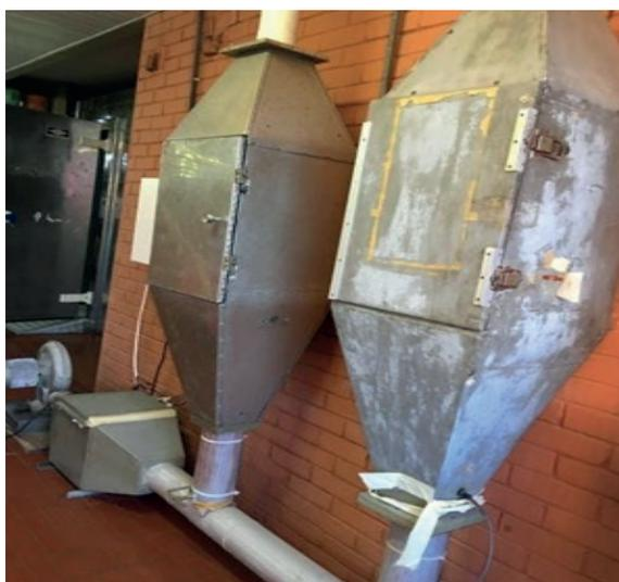
Figura 1. Secador de bandejas utilizado no estudo.
