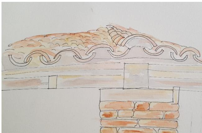
Figura 7 – Croqui do encaixe do pilar da Olaria com o madeiramento do telhado. Nota-se as telhas tipo capa-canal.
