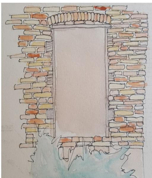
Figura 6 – Croqui da janela frontal do casarão. Nota-se o arco na parte superior e a verga de madeira.
