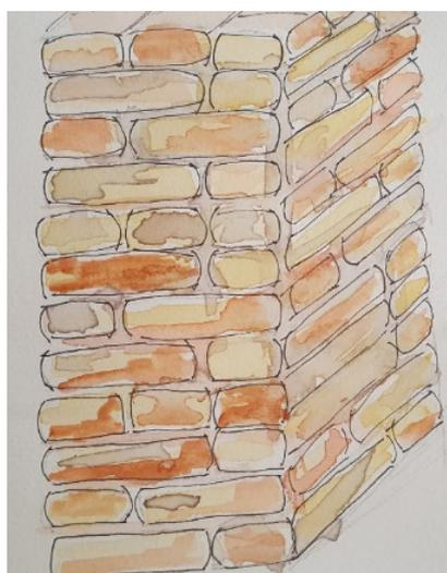
Figura 4 – Croqui dos pilares da Olaria. Alvenaria de uma vez.
