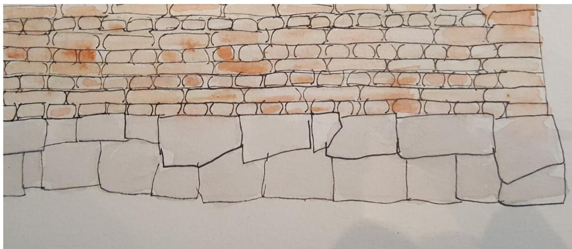
Figura 8 – Croqui do encaixe da base em pedras do casarão com os tijolos da parede.
