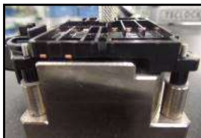
Figura 7 – Folga entre a peça e o Jig de fixação.
