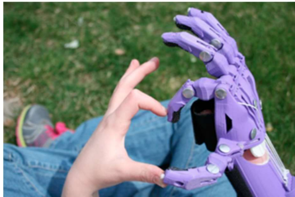
Figura 1 – Modelo de prótese de mão obtida a partir da impressão 3D de modelo disponibilizado na plataforma “ Enable the Future ”
