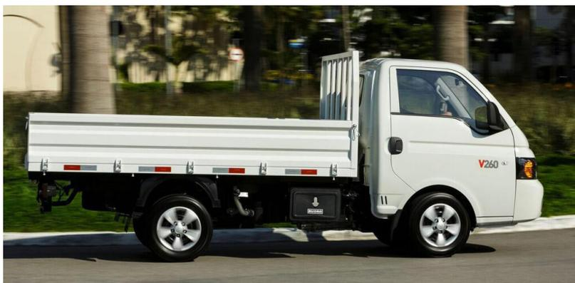
Figura 4.4 - Veículo Urbano de Carga - VUC
