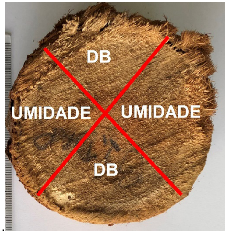
Figura 1 - Divisão dos discos em quatro seções para estudo de umidade e densidade básica. Fonte: Elaborada pelo autor
