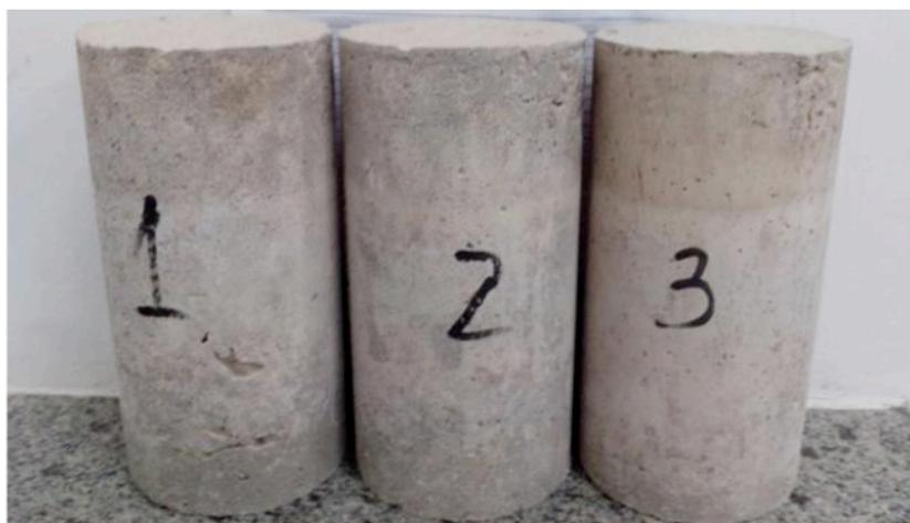
Figura 2 - Efeito da eflorescência nos corpos de prova
