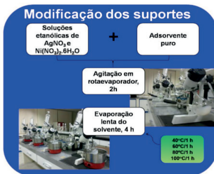
Figura 3. Esquema de modificação dos suportes adsorventes com sais de níquel e prata.
