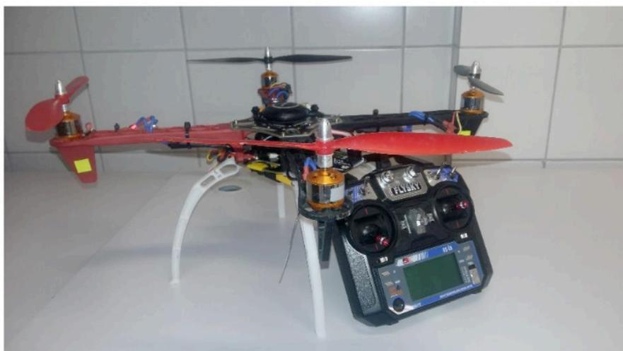
Figura 1 – Quadrotor DJI F450
