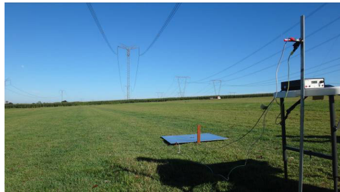
FIGURA 11 – Localização do ponto de medição - equipamentos aterrados e calibrados
