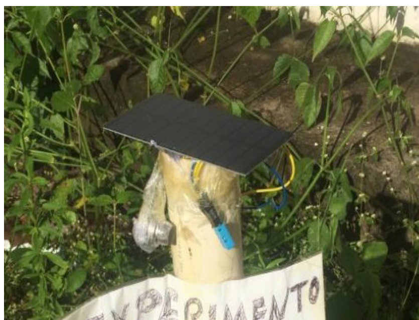
Figura 8 - Protótipo enterrado no campus da universidade.
