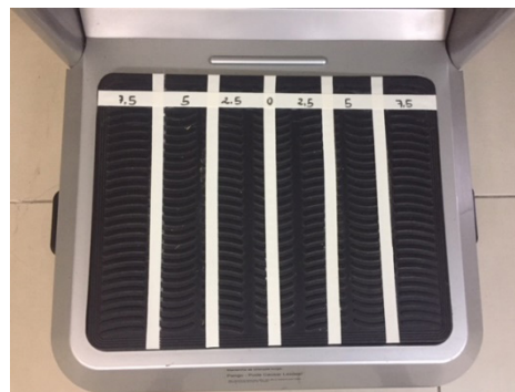
Figura 5- Identificação da marcação referente aos deslocamentos pico-a-pico (2,5; 5 e 7,5 mm), realizada na base da plataforma oscilante/vibratória alternada.
