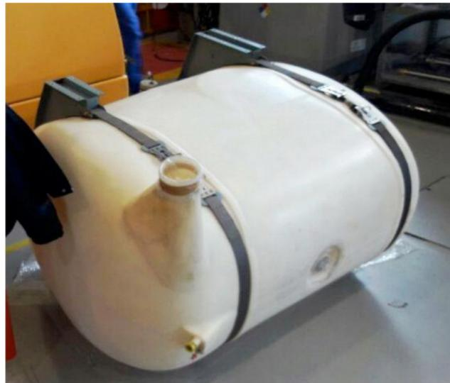
Figura 7 : Tanque original do helicóptero Esquilo AS350
