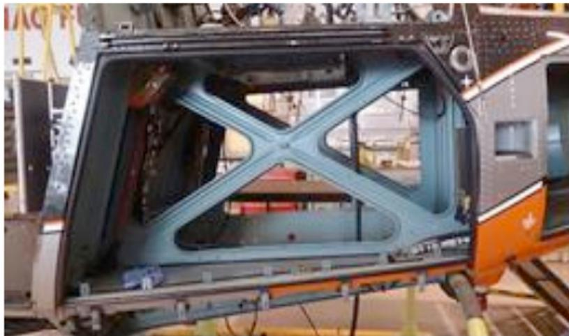
Figura 3: Estrutura compartimento do tanque.
