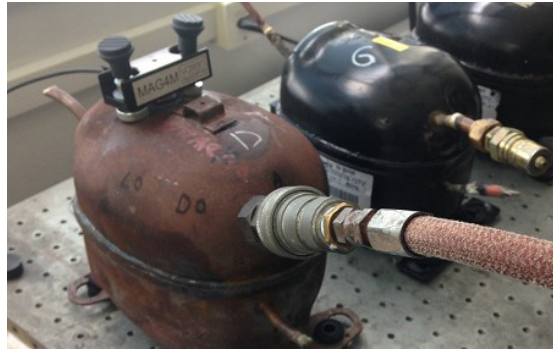
(a) Transdutor acoplado no corpo do compressor no ar.
