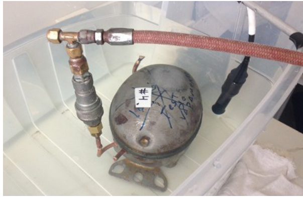
Figura 3.9: Experimento empregando a técnica passiva com hidrofone.
