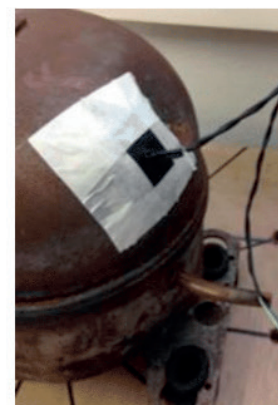
(c) Montagem final com isolamento acústica.
