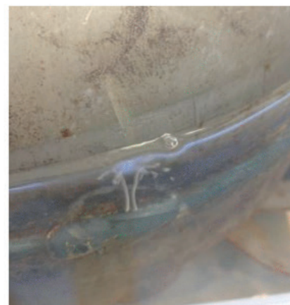
Figura 4.17: Vazamento do compressor #3 em diferentes meios.
