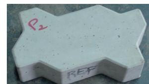
Figura 5: Bloco de concreto intertravado
