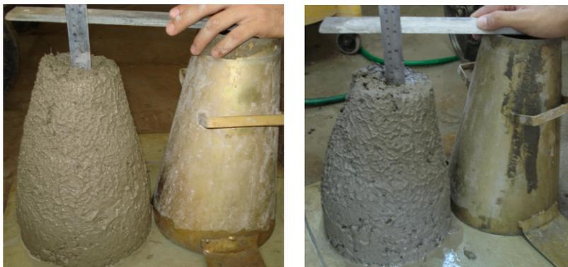
Figura 3 - Consistência pelo abatimento de tronco de cone
