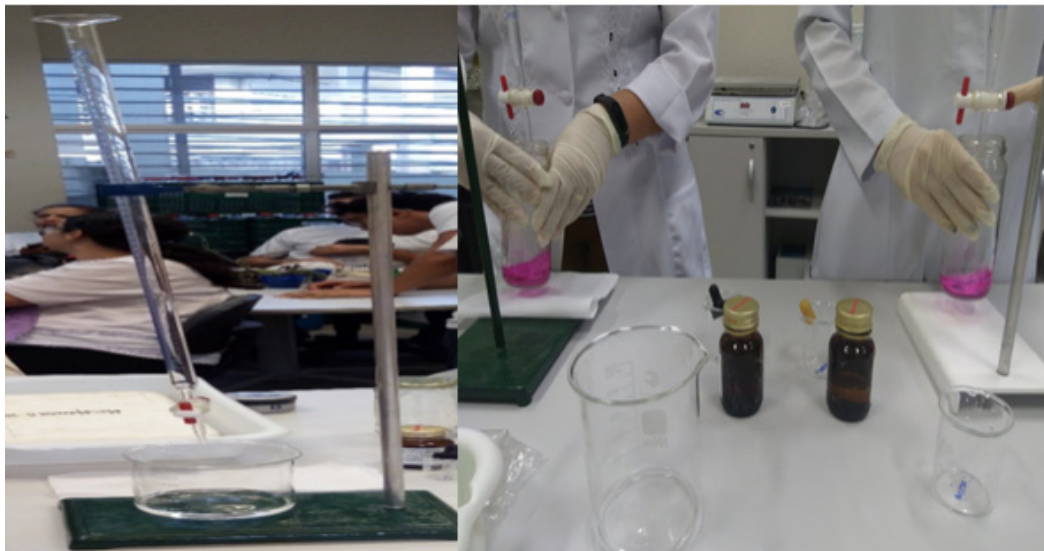
Figuras 5 e 6 - Bureta graduada com torneira, suporte (haste e base) e pinça (garra); e Béquer, indicadores (fenolftaleína e alaranjado de metila) e conta-gotas.
