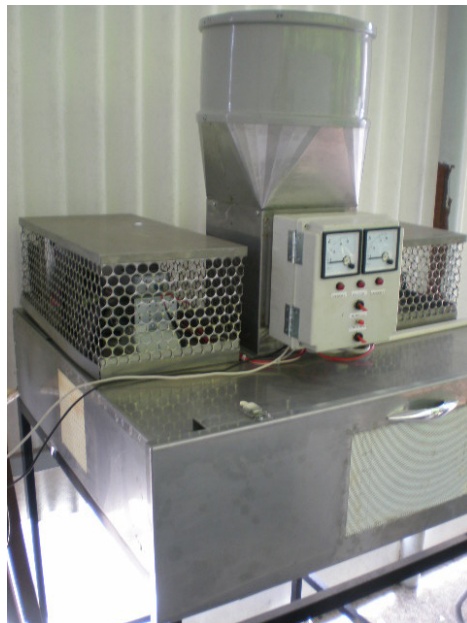
Figura 1 – Foto do secador por micro-ondas e convectivo utilizado após a fase de secagem do café ao sol. Registro no INPI: PI 0804856-8.
