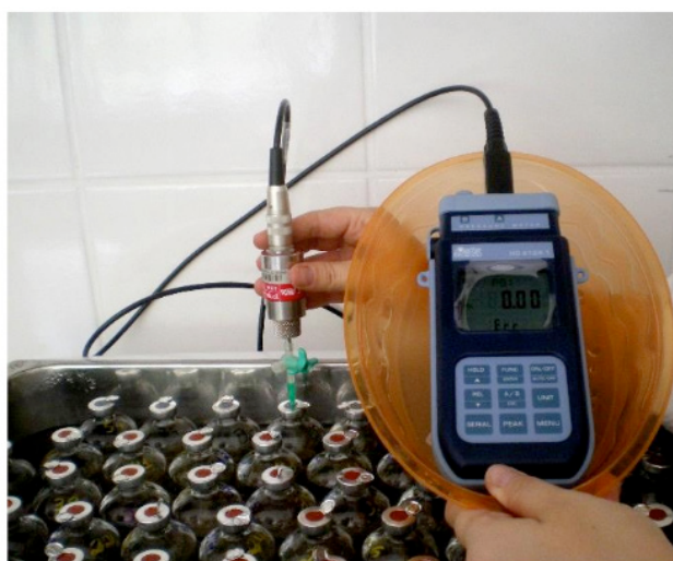
Figura 2: Avaliação da produção de gases in vitro , usando transdutor de pressão digital. Fonte: Menegoti, 2016.
