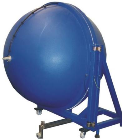
FIGURA 1 – Esfera integradora utilizada para os ensaios fotométricos
