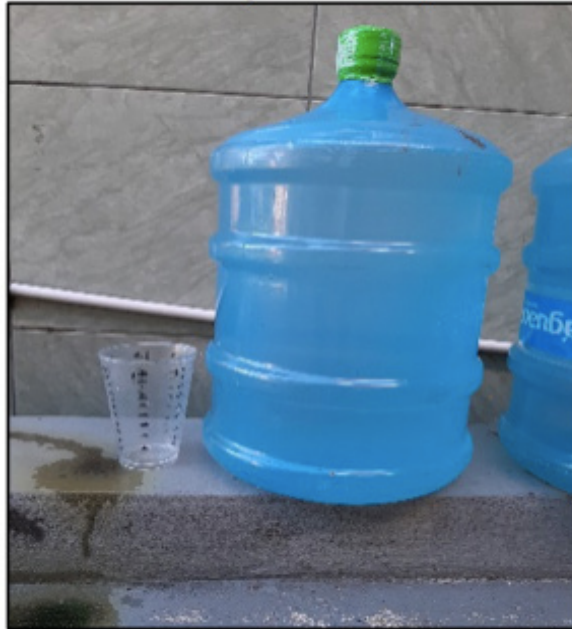
Figura 3 - Medição da coleta de água dos aparelhos de ar condicionados Fonte: próprio autores (2019)
