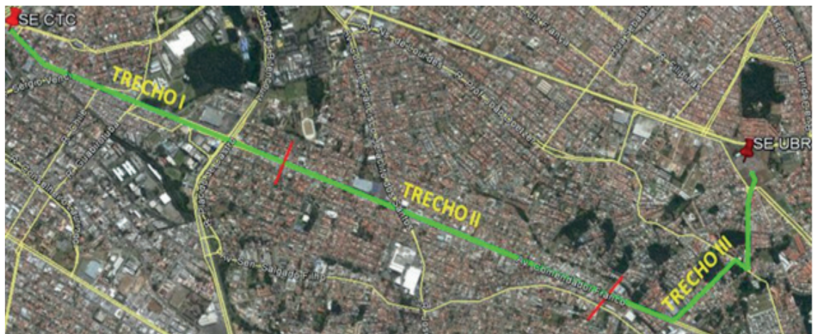
FIGURA 7 – Frentes de trabalho para implantação da LTS 230kV CTC-UBR.
