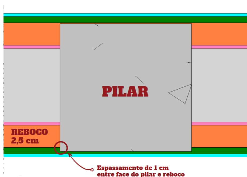
Figura 4 - Desaprumo entre pilar e reboco 2,5 cm.
