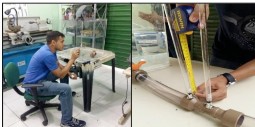
Figura 1. Dimensionamento e construção do sistema fluido composto de reservatório, válvula, Tubo de Venturi e tubulações de \Phi 5,0\text{cm} .
