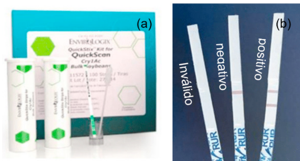
Figura 6. Ilustração do Kit para teste de OGM's em grãos de soja (a), assim como fitas utilizadas para os testes de transgenia (b).
