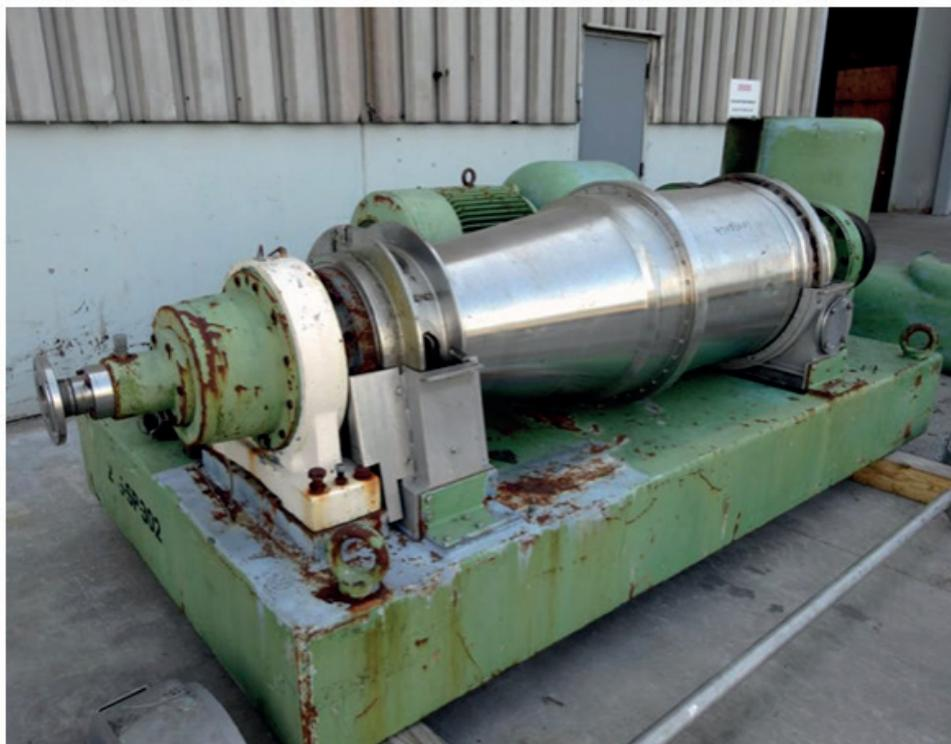
Figura 4 - Separador centrífugo horizontal utilizado em experimentos.
