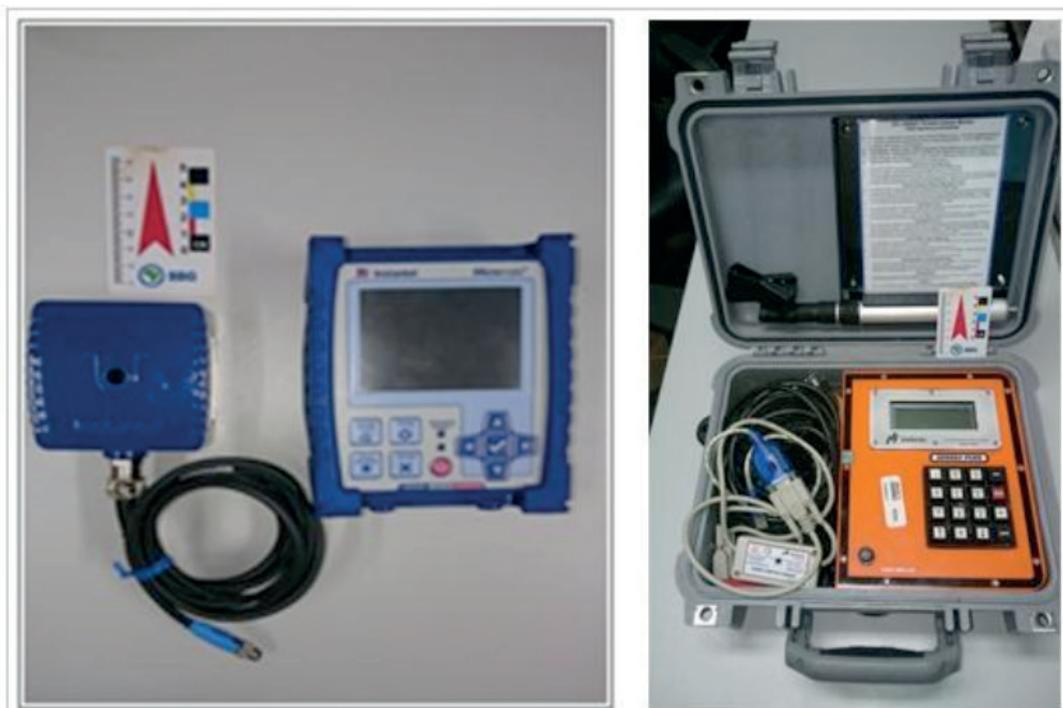
Figura 3: Sismógrafos utilizados nos estudos
