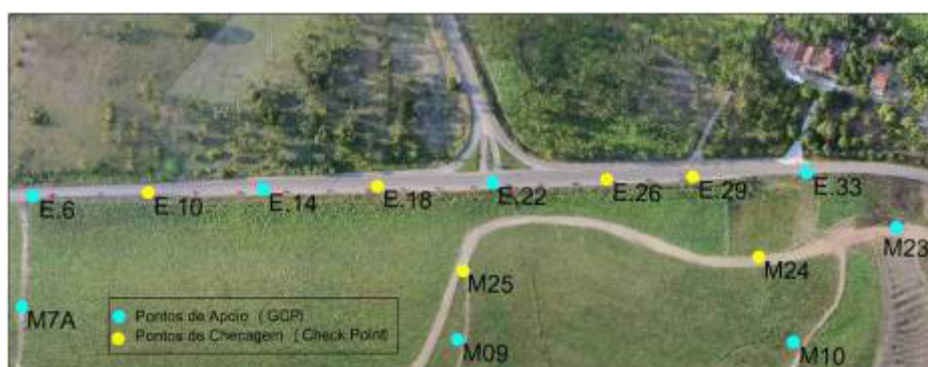
Figura 7 - Localização dos marcos pré-sinalizados utilizados como marcos de apoio (GCP) e marcos de controle (Check Point).
