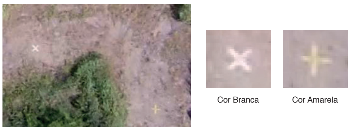
Figura 9 – Detalhe da sinalização com tecido implantados de cor Branca e Amarela.
