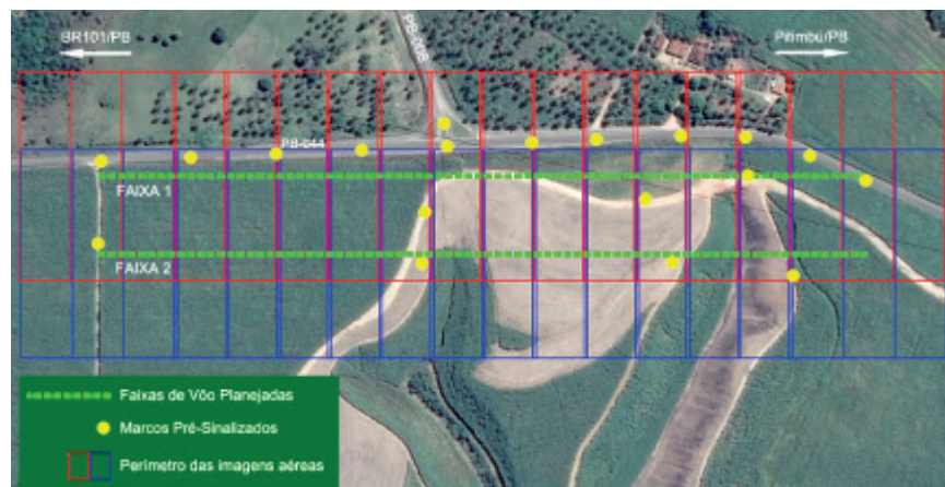
Figura 5 – Vista do programa Microstation com o planejamento das faixas de Vôo e posição dos marcos pré-sinalizados.
