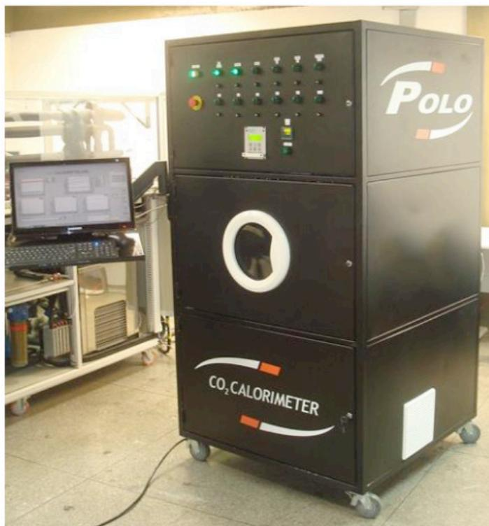
Figura 1: Calorímetro de ciclo quente para compressores de dióxido de carbono.
