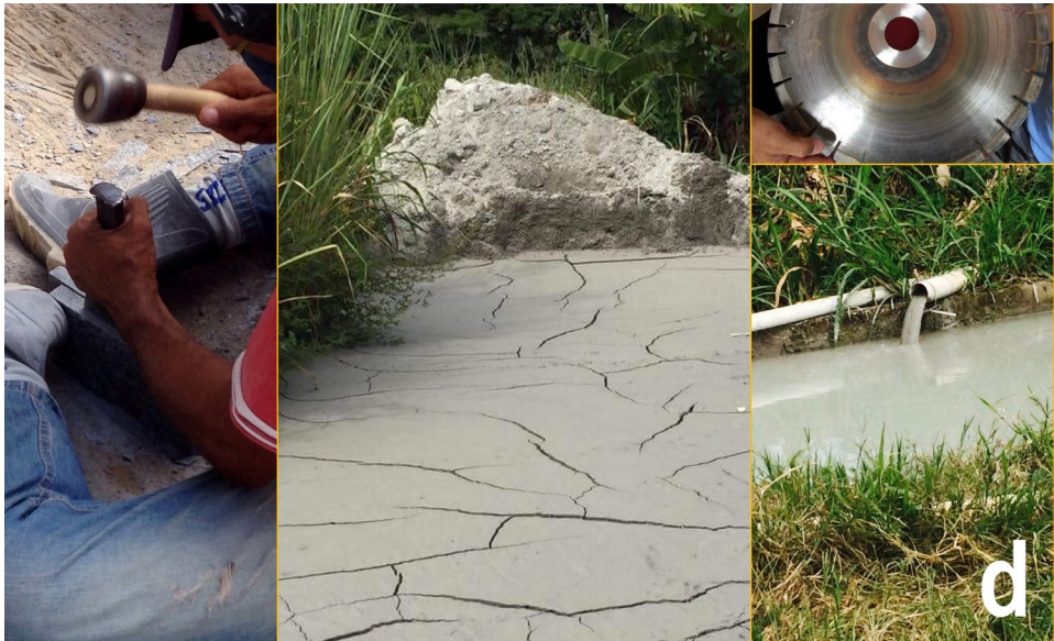
Figura 6. Imagens relacionadas ao trabalho nas Serrarias: (a) Trabalhador utilizando instrumentos para quebrar a pedra bruta. Os resíduos são fragmentos em lascas; (b) Resíduo sólido, lama compactada que formou um argilito e exhibe fraturas de contração do volume após a evaporação da água; (c) Disco diamantado utilizado no processo de corte das rochas, uma etapa do beneficiamento; (d) Resíduo líquido do escoamento da água a céu aberto com micropartículas finas, do pó de corte das pedras que dá origem à lama.
