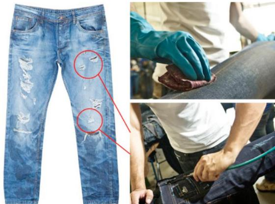
Figura 5. Acabamento manual por lixamento e por puído.
