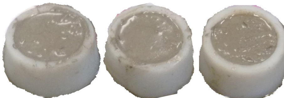
Figura 6 – Exsudação dos compósitos dosados com o aditivo I (compensado, eucalipto e pinus)
