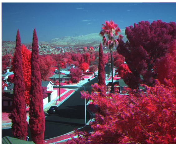
Figura 12 – Imagem em falsa cor adquirida pela câmera multiespectral da TETRACAM.
