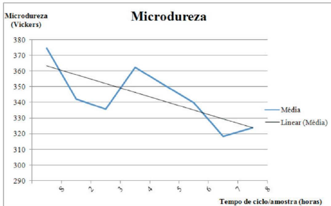
Figura 3: Valores médios de dureza em Vickers x tempo de envelhecimento. Autores, 2015.
