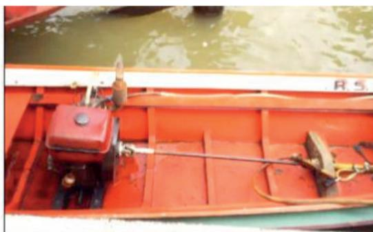
Figura 2: Embarcação ribeirinha com eixo de motor sem proteção.
