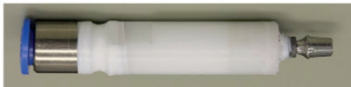
Figura 18. Plugue conectado ao tubo de plástico e vedado com teflon
