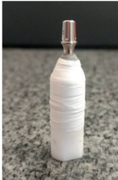
Figura 14. Interface entre implante e pilar vedada com resina flow + resina micro híbrida envoltas por teflon
