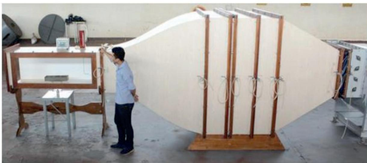
Figura 8: Túnel de vento a ser usado nos ensaios de vibração.
