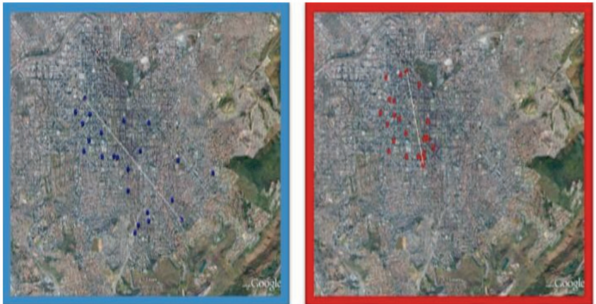
Figura 10 - Comparação da distância a ser percorrida pela equipe executora utilizando o método convencional (azul) e o proposto (vermelho). Para o método convencional, deslocamento de 28,9km (máxima de 3,3km), atuando em 23 UC's.
