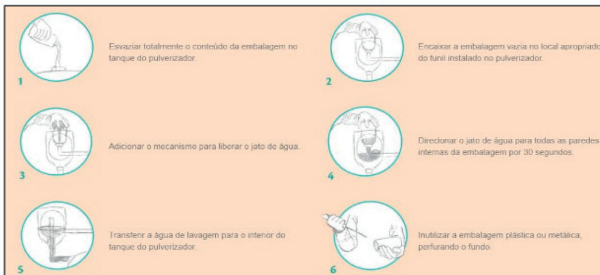
Figura 3 – Lavagem sob pressão
