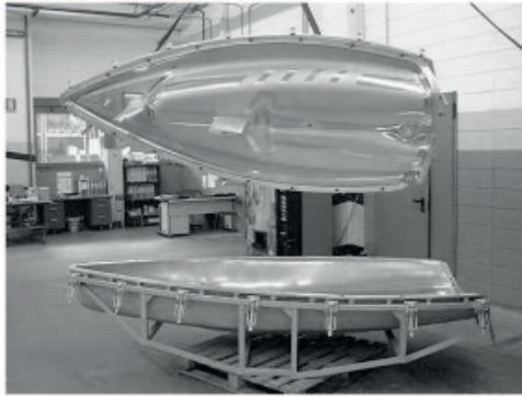
Figura 01: Molde de alumínio fundido Fonte: Crawford (2003, p. 30)
