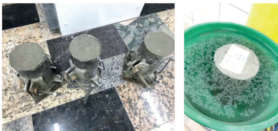
Figura 1 – Moldagem e cura dos corpos de prova
