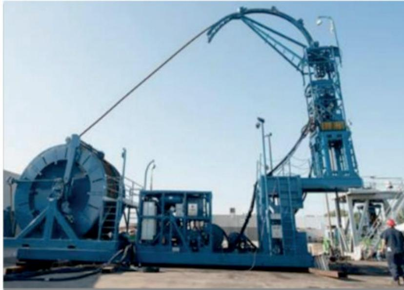
Figura 1 – Sistema coiled tubing (Fonte: GROVER e BARDEN, 2015).
