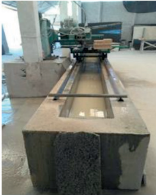
Figura 2. Tanque de decantação
