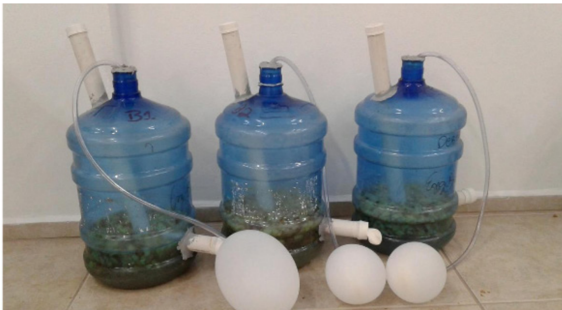
Figura 4- Biodigestores de maçã abastecidos e com o biogás armazenado nos balões.
