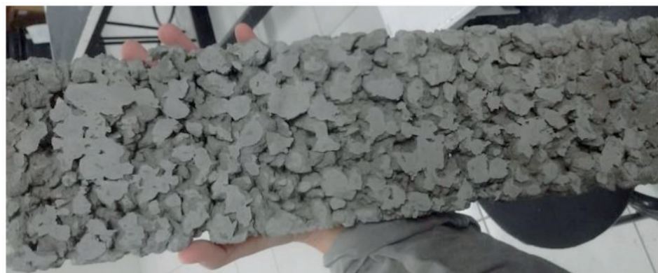
Foto 1: Vista inferior da placa após desenformada.
