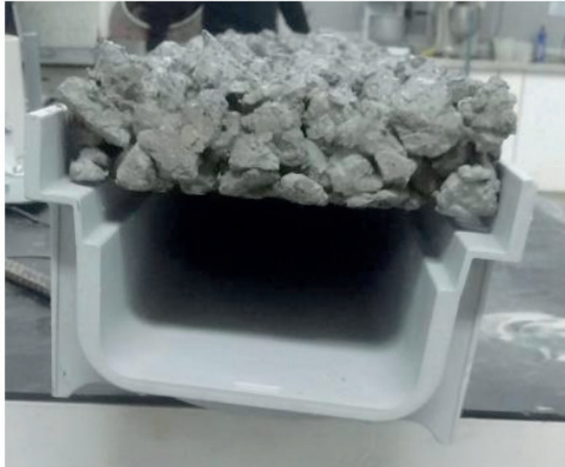
Foto 3: Vista frontal da placa inserida no condutor de água.
